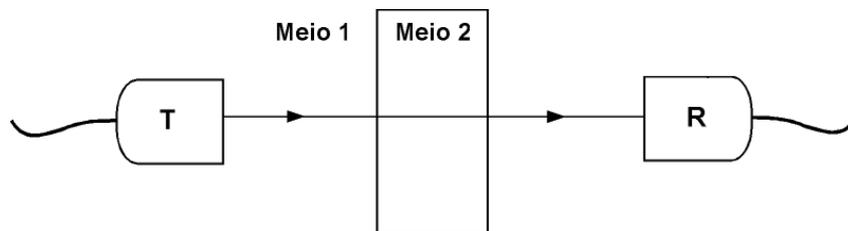
Figura 6 - Método transmissão-recepção. São utilizados dois transdutores, um transmissor (T) e um receptor (R).
