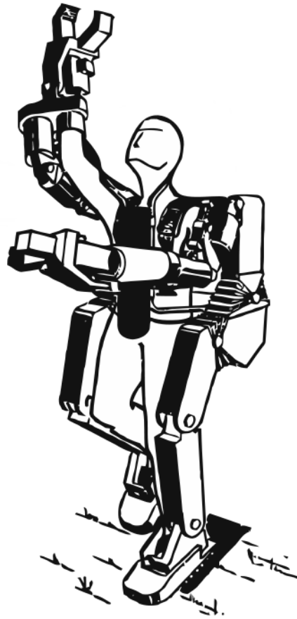
Figura 13: Figura conceitual de um exosqueleto adaptada do projeto Hardiman I da General Electric [Fick e Makinson, 1971].
