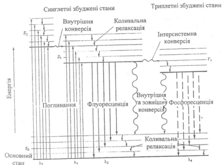
Рис. 28.5. Схема енергетичних рівнів і можливих переходів між ними (пояснення в тексті)
