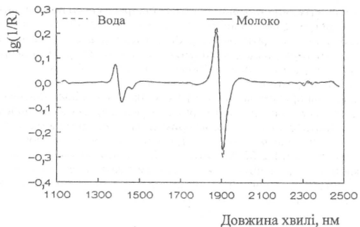
Рис. 30.29. Перша похідна від спектрів відбивання молока та води в ближній інфрачервоній області
