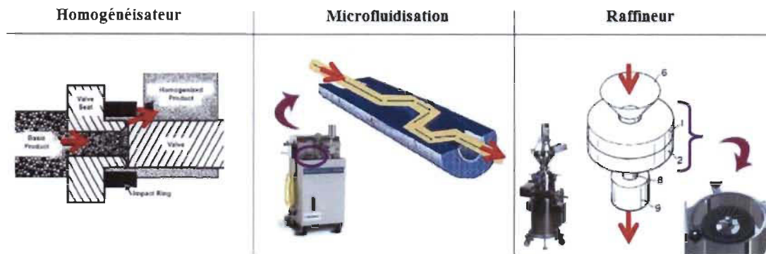
Figure 2.14 Principaux procédés employés pour les traitements mécaniques des fibres celluliques [123]
