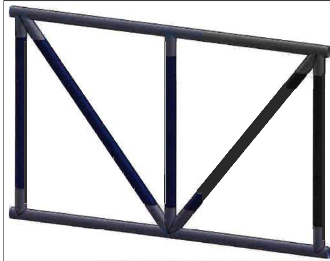
Figure 2.25 Zones de design (en bleu) et de non-design (en gris) d'une structure tubulaire
