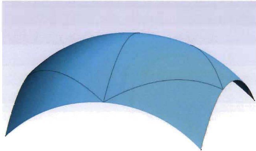
Figure 3.11 Coque maillée avec six éléments
