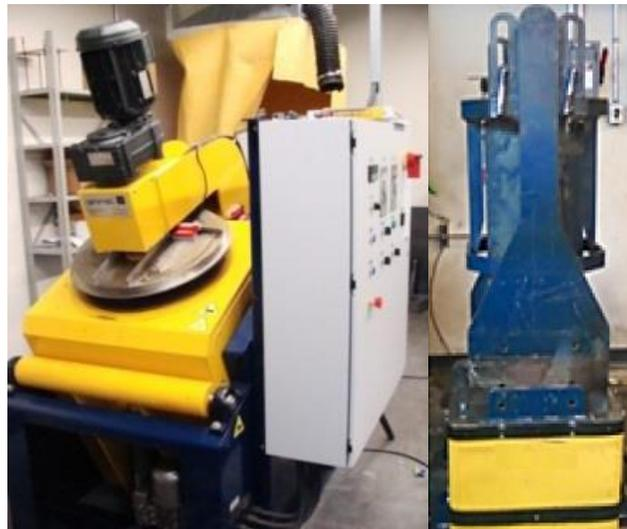
Figure 3.6. a) Mixeur à l'UQAC, b) Vibrocompacteur à l'UQAC.
