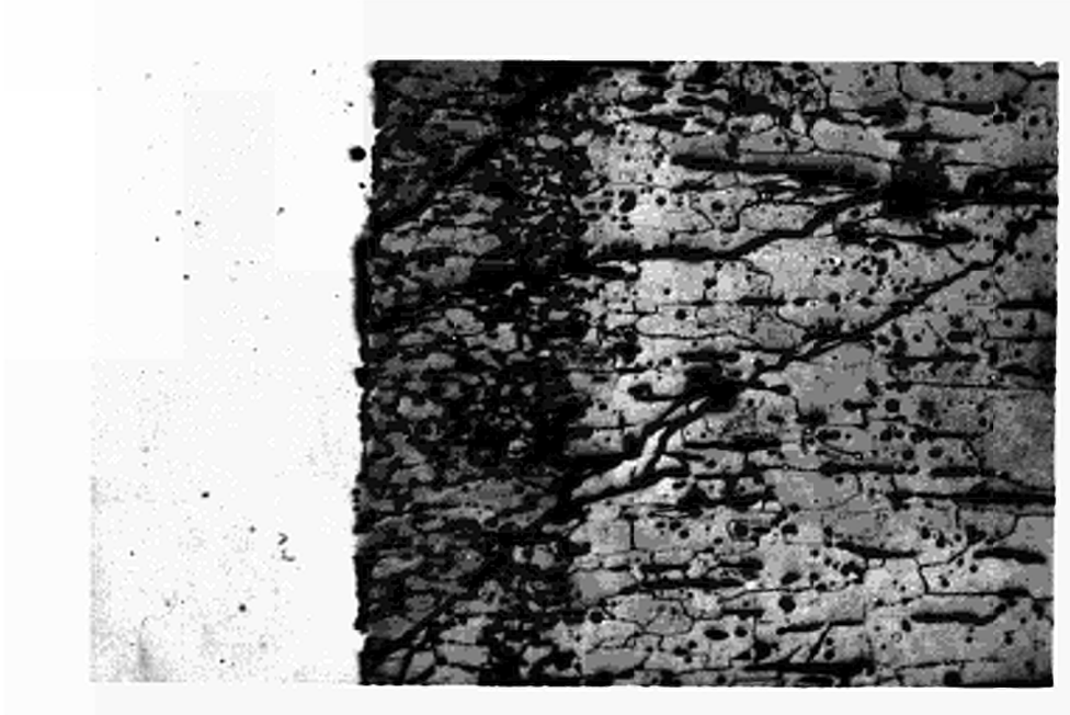
Fig. 9 - Contact Mo- \text{UO}_2 - Structure basaltique du combustible
