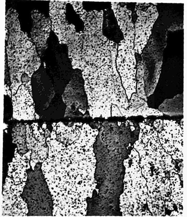
Fig. 9 - Pièce rodée "marbre", T = 1300^{\circ}\text{C} , t = 1 heure, P = 330\text{kg}/\text{cm}^2
