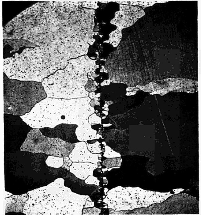
Fig. 13 - Pièce polie Al 2 O 3 (T = 1400°C, t = 1 heure, P = 330 kg/ cm 2 + 4 heures recuit 1800°C)
