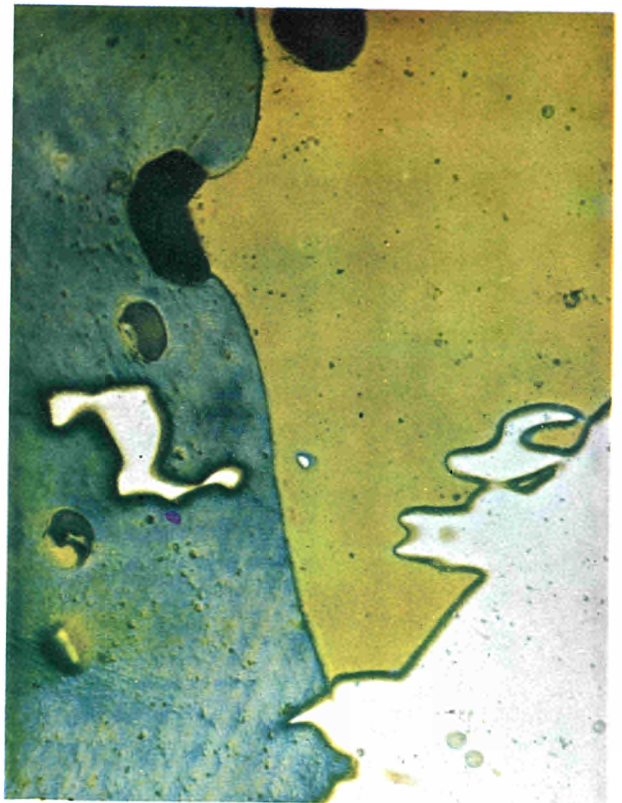
Fig. 2 - ( x 460 ) - métal ( tungstène ) en inclusion dans le molybdène.
