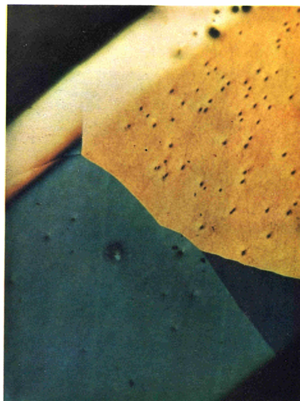
Fig. 8 ( x 90 ) - diffusion intermétallique molybdène - rhénium.
