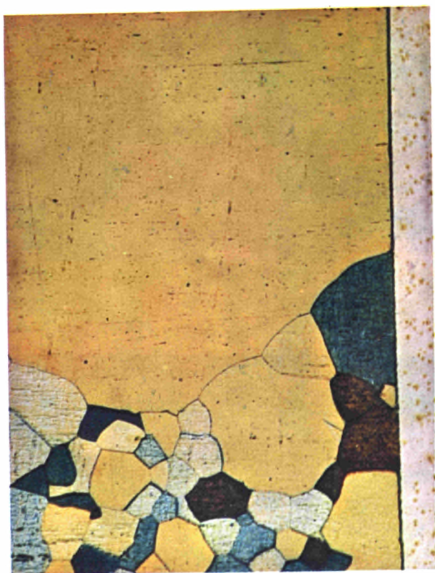
Fig. 5 - ( x 76 ) - monocristal de molybdène obtenu par un maintien de 3 heures à 1750° C.
