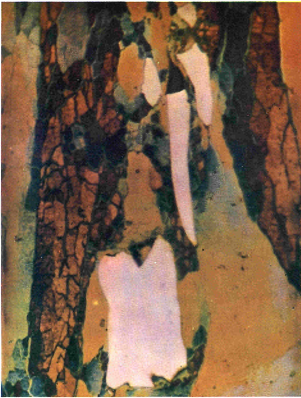
Fig. 1 - ( x 800 ) - Composés en inclusions dans le molybdène.
