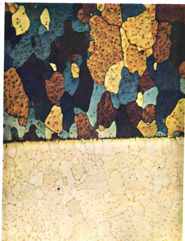
Fig. 7 ( x 76 ) - jonction molybdène-tantale.
