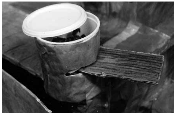
In einem STEP-Kindergarten konstruierten Kinder in einem Projekt einen Roboter, aus dem Bonbons portioniert herausfallen. Die Abbildung zeigt den Portioniermechanismus.
