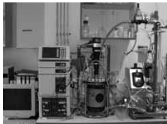
Pilotanlage im Biogaslabor zur Herstellung von Biogas aus Molke (Flüssigfermentation)
