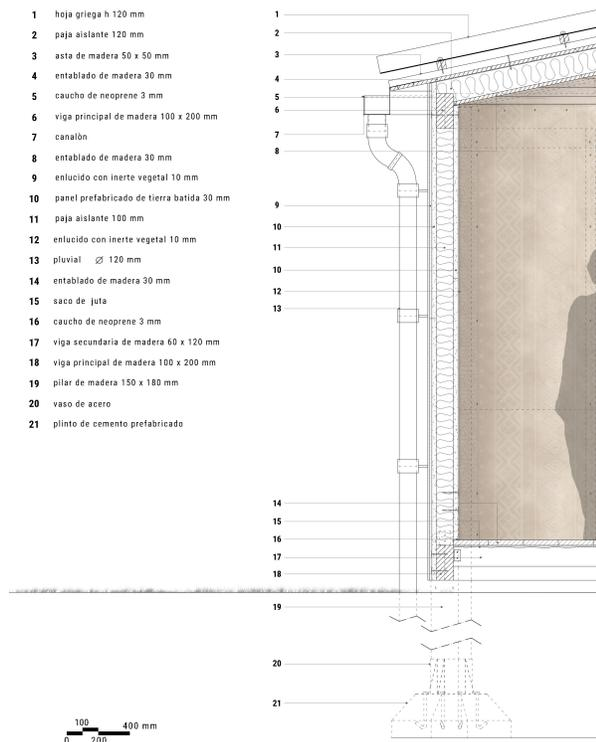
(Figura 2. Detalles / Sección )
