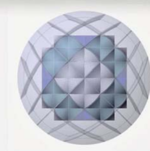
12 Medias bóvedas hyper (módulo 3). Los cuadriláteros que no abarcan el casquete de cúpula se cubren mediante dos fragmentos de hyper, que se corresponden con media bóveda parabólico hiperbólica.
