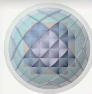
11 Bóvedas hyper (módulo 2) Toda la superficie del casquete de la esfera se cubre mediante bóvedas parabólico - hiperbólicas.
