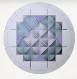
15 Contrafuertes Los arcos estructurales transmiten sus esfuerzos a los contrafuertes. Estos se sitúan en la intersección de las dos familias de arcos.
