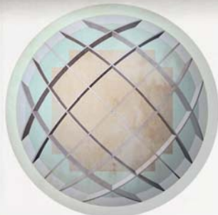
9 Sección de arcos estructurales Los arcos seseccionan mediante un plano horizontal que será el suelo.
