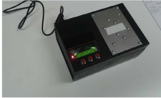
Figura 37: Fotografía de la nueva versión del patrón, con el que se han realizado los ensayos de calibración y comprobación de las mediciones con termómetros de infrarrojo.
