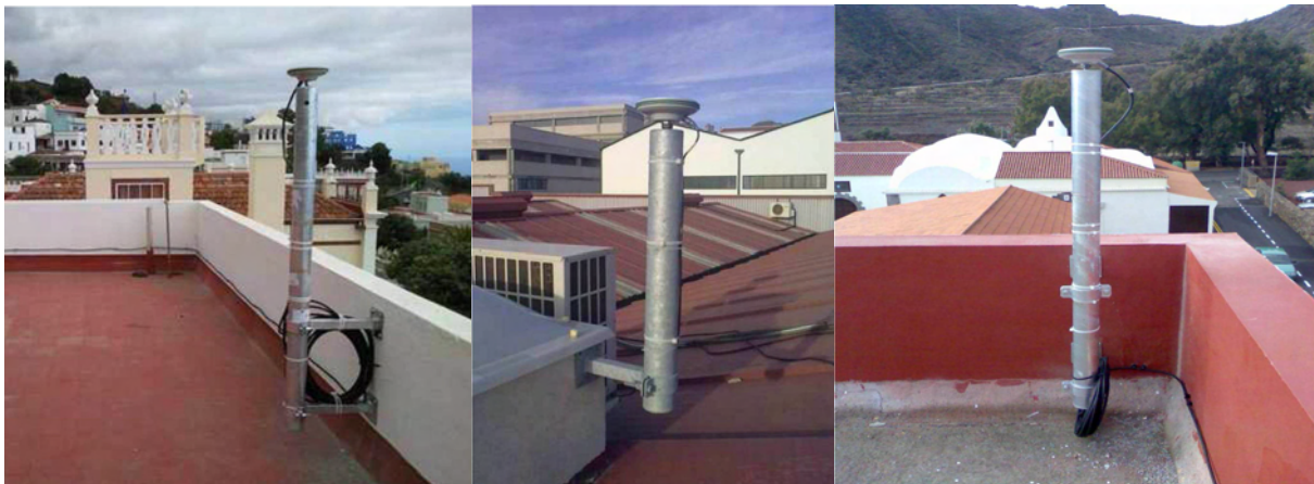
Figura 3.13: Estaciones permanentes GNSS de GRAFCAN desplegadas recientemente para usos cartográficos, geodésicos y de posicionamiento general: a) estación de Mazo en La Palma, b) estación de Santa Cruz en Tenerife y c) estación de Santiago del Teide también en Tenerife. Su uso para fines geodinámicos habría que constatarlo cuando se disponga de una serie larga de observaciones (de la IDE GRAFCAN)
