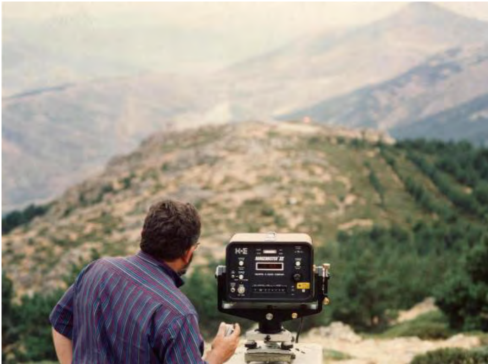
Figura 1.2: Observación geodinámica con equipos EDM RangeMaster III en el Estrecho de Gibraltar. La Red Geodinámica de Observaciones del Estrecho de Gibraltar (RGOG) se desarrolló en los años 1982/83 por los centros geodésicos oficiales de España y Marruecos para monitorizar el Estrecho de Gibraltar, a fin de iniciar los estudios de un proyecto de comunicación estable en el mismo. La red se observó en 1984, 1989 y 2008. Comprende observaciones entre estaciones a cada lado del Estrecho de ángulos horizontales y verticales, distancias mediante EDM, nivelación NAP, determinaciones astronómicas de latitud, longitud y acimut y, posteriormente GNSS. El equipo RangeMaster III, si bien no tiene una precisión excesivamente alta ( \pm 5 \text{ mm} + 1 \text{ ppm} ), su alcance máximo es de 60 km que lo hace muy recomendable para redes de lado largo, como es el caso de la RGOG. El sistema utiliza un láser He-Ne de 632,8 nm de frecuencia visible. Se puede apreciar en la imagen el retorno del haz rojo emitido y devuelto por la estación remota.
