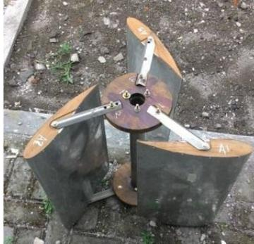
Gambar 5 Turbin Angin dengan NACA 0018 modifikasi
