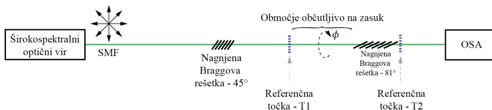
Slika 1-19: Senzor rotacije/zasuka, zgrajen z nagnjeno Braggovo rešetko.
