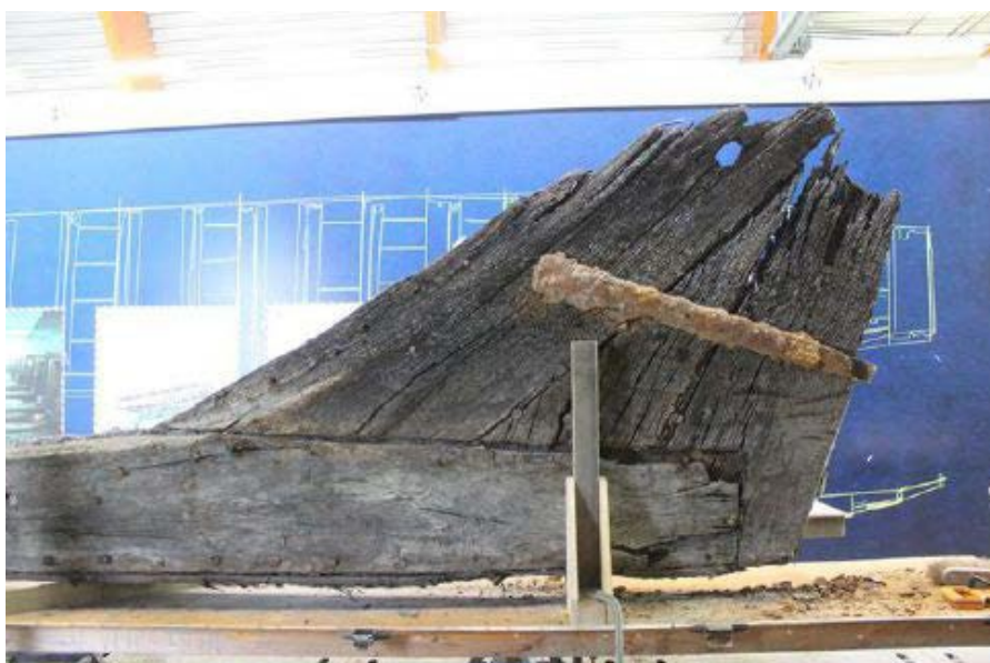
Fig. 13. Achtersteven van OE 34, stuurboord aanzicht.
