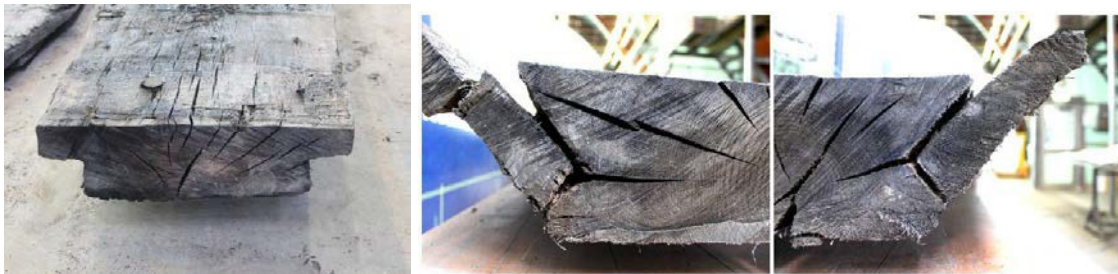
Fig. 8a en b. Vorm van de kielplank van OE 34: T-vormige kiel (a) en kiel met sponning (b).
