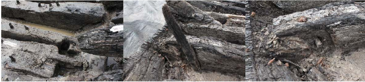
Fig. 21. Spouwingen in de leggers van de hoofdspanten van OE 34 (spanten van oprichting).
