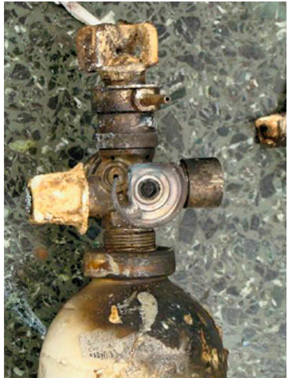
FIGUUR Foto van een uitgebrande zuurstofcilinder met reduceerventiel. De hoofdafsluiter van het reduceerventiel bevindt zich bovenin, de flowregelaar in het midden. De brand ontstond bij het openen van de hoofdafsluiter terwijl de flowregelaar al geopend was.
