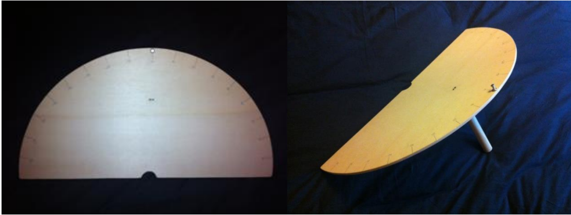
Figuur 11: De gebruikte boog. Op het moment dat de observator het object waarneemt wordt met behulp van deze boog de hoek bepaald. De neus van de observator wordt daarbij geplaatst in de inkeping en er wordt gefixeerd gekeken naar het focus punt op 0^\circ .
