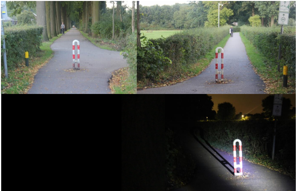
Figuur 33: Foto's van het fietspaaltje genomen op controlelocatie A (Bunnik) bij daglicht zowel naar de kruising toe (linksboven) als van de kruising af (rechtsboven), bij duisternis (linksonder) en gedurende duisternis bij aan schijnen door fietsverlichting (rechtsonder).
