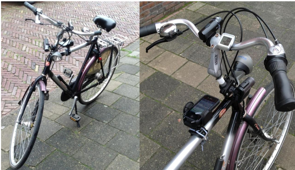
Figuur 1: Een overzicht van de gebruikte geïnstrumenteerde fiets (links) en de daarop geïnstalleerde meetapparatuur (rechts). Op de 'stang' bevindt zich de iPhone, aan de stuurpen de Contour+2 camera, op het stuur een LED fietslamp (links) en de fietscomputer (rechts).
