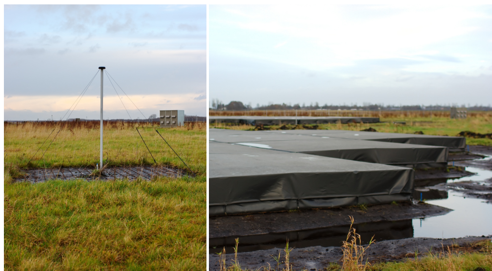
Figuur 2: De twee soorten LOFAR-antennes. Afbeelding links: een lage-bandantenne met een kabinet in de achtergrond. Afbeelding rechts: deel van een station met hoge-bandantennes. Deze stations bestaan uit 24 tegels van 4 \times 4 antennes.
