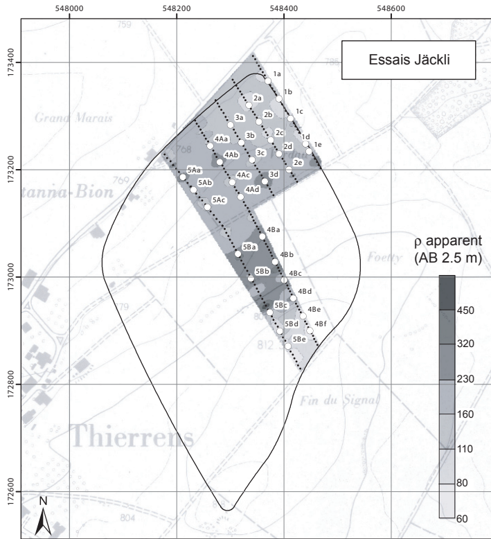
Fig. 51 - Emplacement des essais d'infiltration Jäckli.
