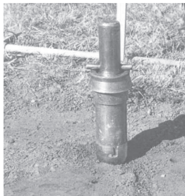
Photo 1 - Echantillonneur utilisé pour le prélèvement des matériaux.
