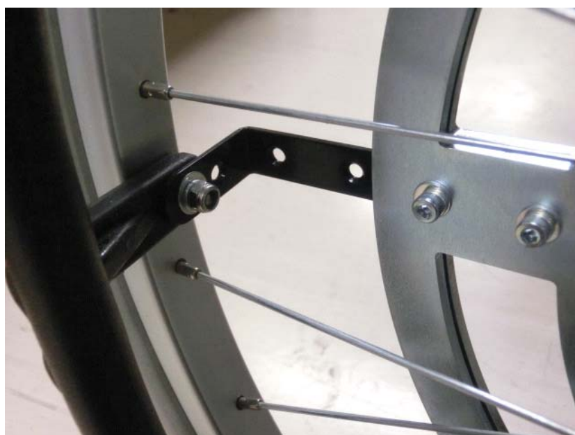
(b) ハンドリムの取り付け穴を用いてインターナルギヤを取り付ける
