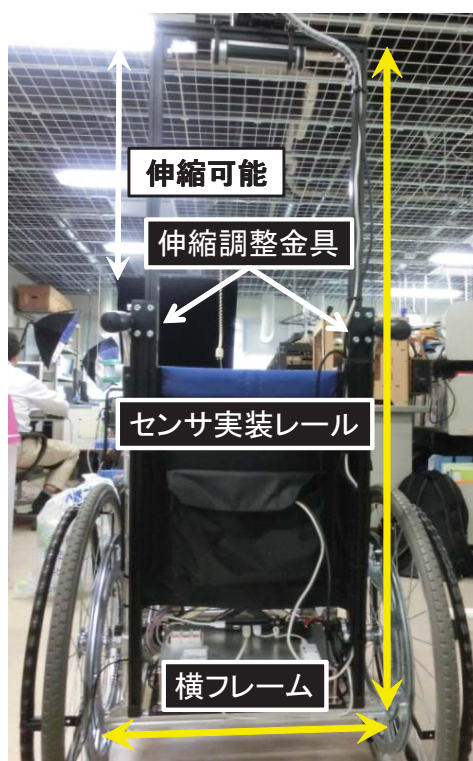
(b) 車体後部のアルミフレームの取り付け構造
