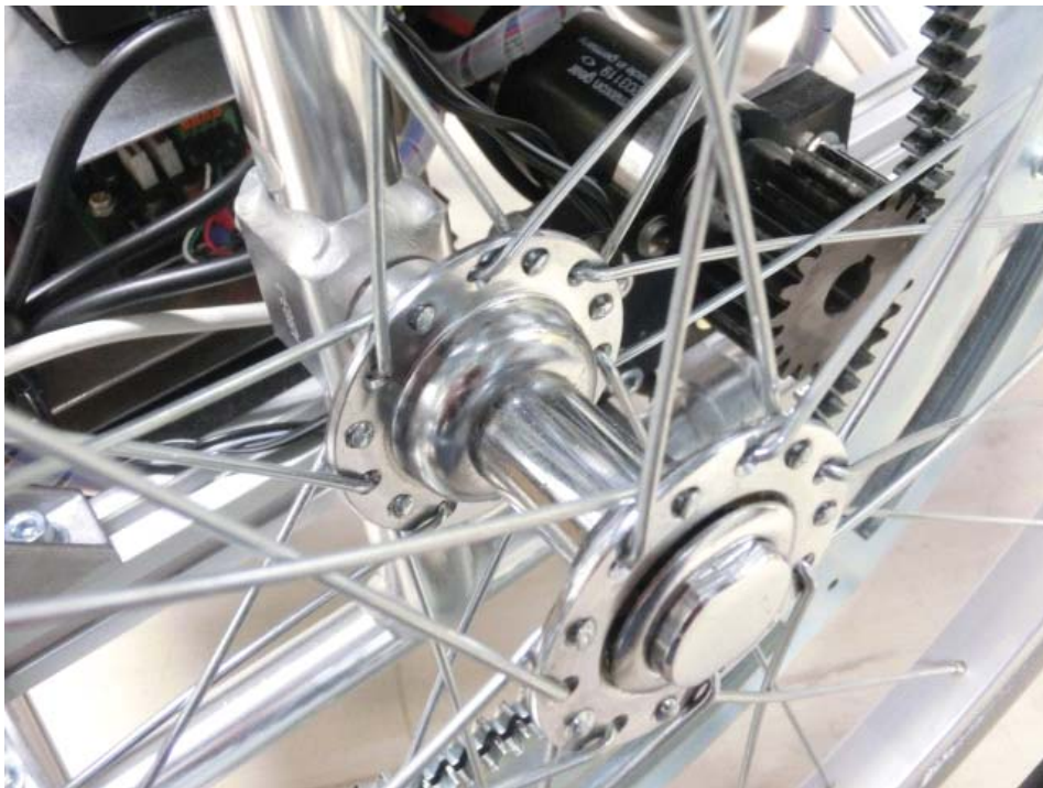
図 B.6: ハブとスポークで構成された一般的な車椅子のホイール軸
