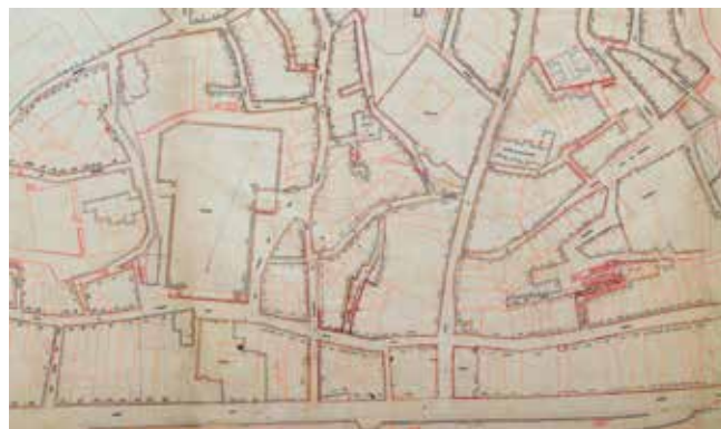
Fig. 4. Detall del plànol a escala 1:300 georeferenciat. En vermell les línies de la cartografia topogràfica actual i en negre les línies del plànol de Fontseré, 1865, reg. PLA_00006-PLA_00008. Arxiu Municipal de Lleida.
