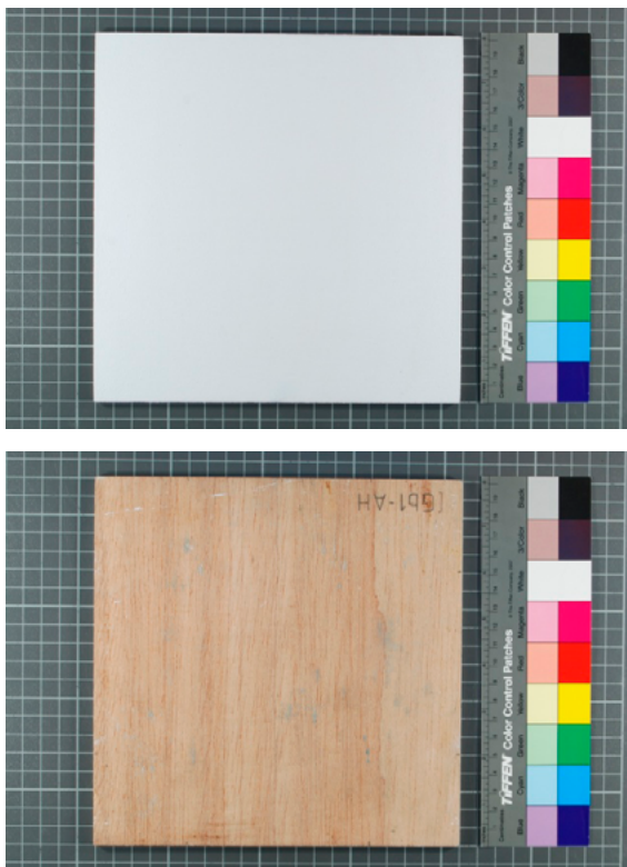
Figura 8. Probeta Gb1-AH después del ensayo de envejecimiento por alta humedad donde se aprecian ligeras manchas de moho tanto en la superficie pictórica como por el soporte de tablero contrachapado.
