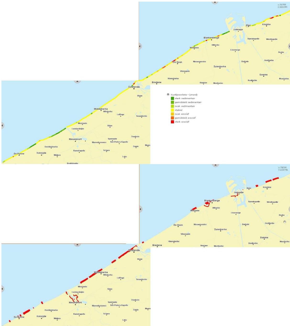
Figuren 16 en 17: Kustlijnevolutie ter hoogte van het strand (boven) en zwakke zones zeevering (onder) [Bron: http://www.kustatlas.be/map/?lan=nl&theme_id=5 , geraadpleegd op 7/11/2012] xciix .
