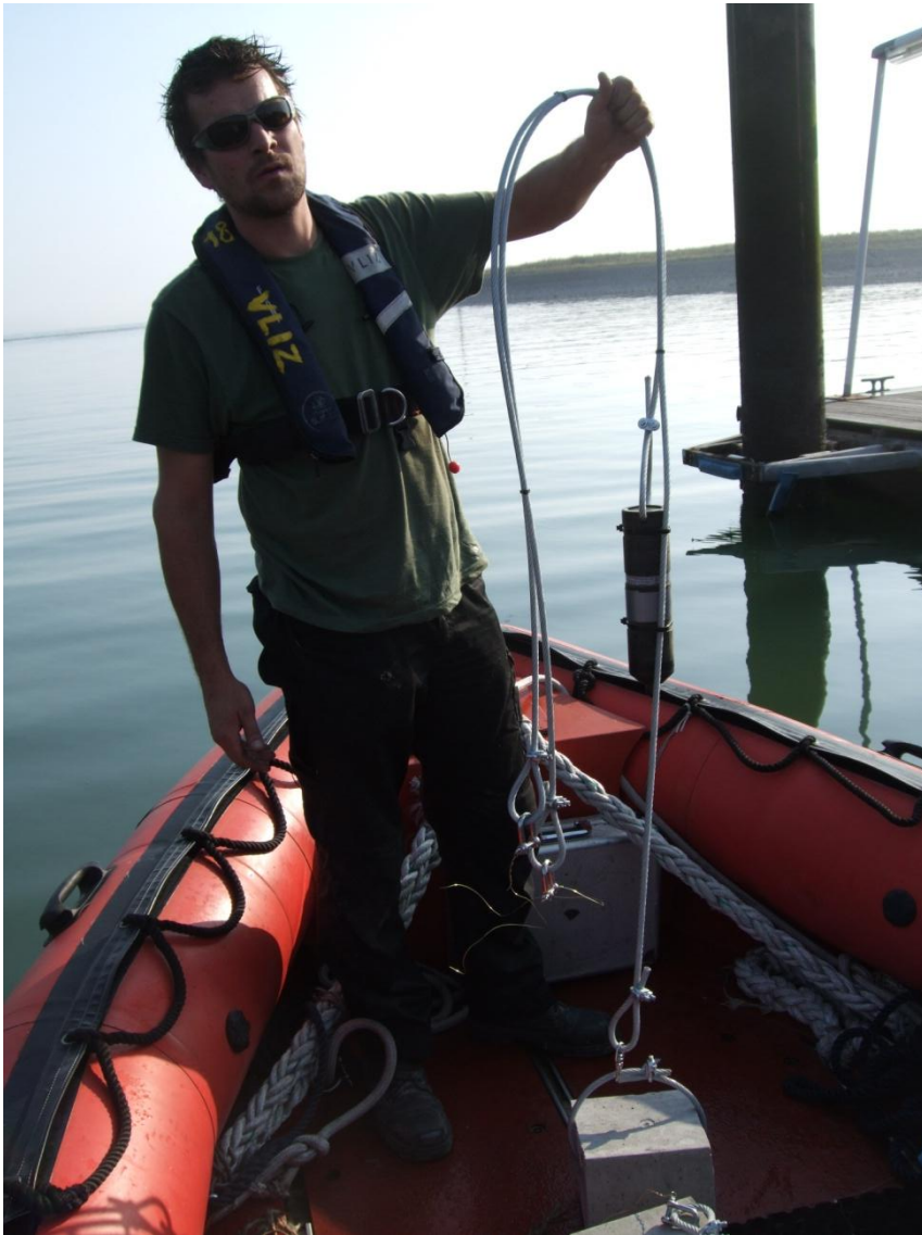
Fig. 15. Constructie waarmee de akoestische receivers werden bevestigd aan de scheepvaartboeien in de Westerschelde.
