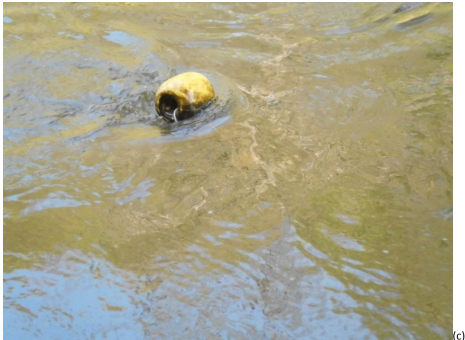
Figuur 11 De akoestische receiver (zwart) is bevestigd aan een gewicht en wordt met behulp van een stalen kabel (a) aan een obstakel langsheen het water bevestigd (een boom, een brugpijler, een piket of een muur; b). De receiver wordt door de kabel en/of een boei verticaal gehouden tijdens de metingen (c).
