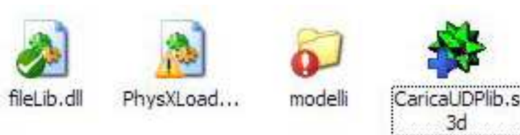
Figura 5.17: I simboli sovrapposti alle icone indicano lo stato del file. In figura da sinistra a destra: versione aggiornata, conflitto avvenuto durante l'upload, file modificato, file da aggiungere al controllo di versione
