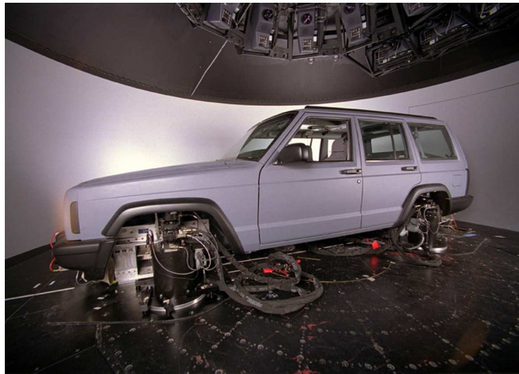
Figura 2.8: Sistema visivo del simulatore NADS-1. Il sistema visivo è costituito da display che coprono un angolo di 360 gradi e da otto proiettori. Le immagini sono aggiornate con una frequenza di 60 Hz.
