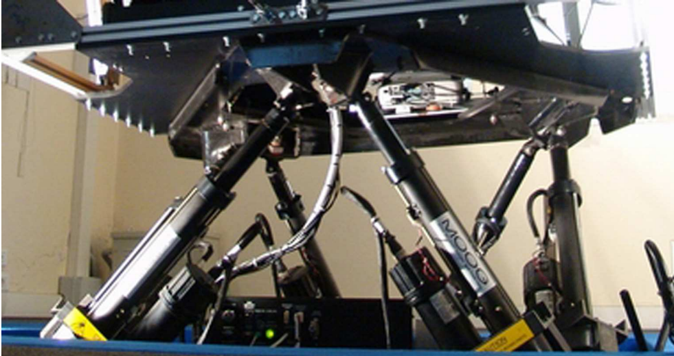
Figura 3.3: Immagine della piattaforma di Stewart installata nel simulatore INDICA.
