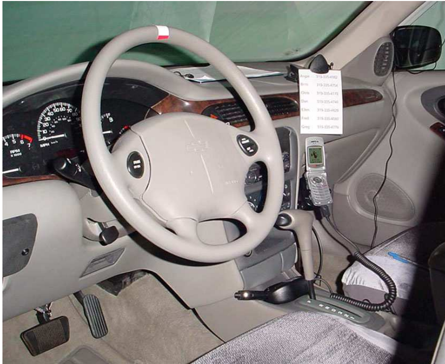
Figura 2.2: Immagine dell'abitacolo della vettura fornita di kit per l'uso del cellulare senza mani, utilizzata nel simulatore NADS-1 per lo studio degli effetti del cellulare sulla guida.
