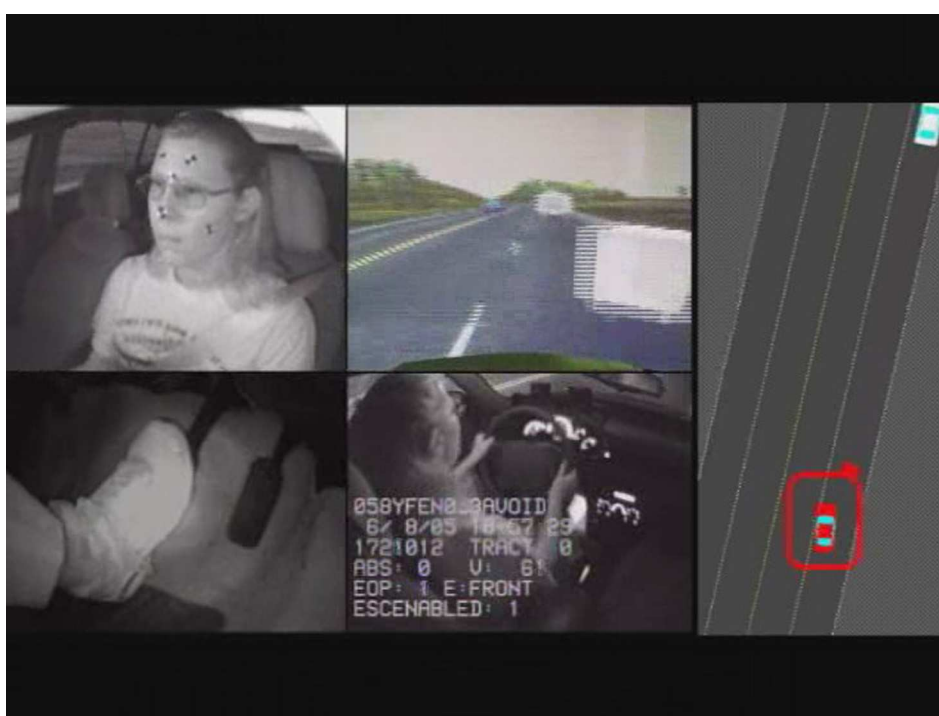
Figura 2.1: Immagine della prova di un volontario alla guida del simulatore NADS-1 per la ricerca relativa al sistema ESC.
