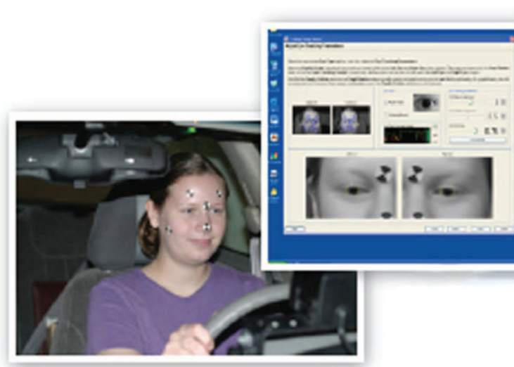
Figura 2.3: Sistema per l'acquisizione dei dati relativi al movimento degli occhi utilizzato dal NADS.
