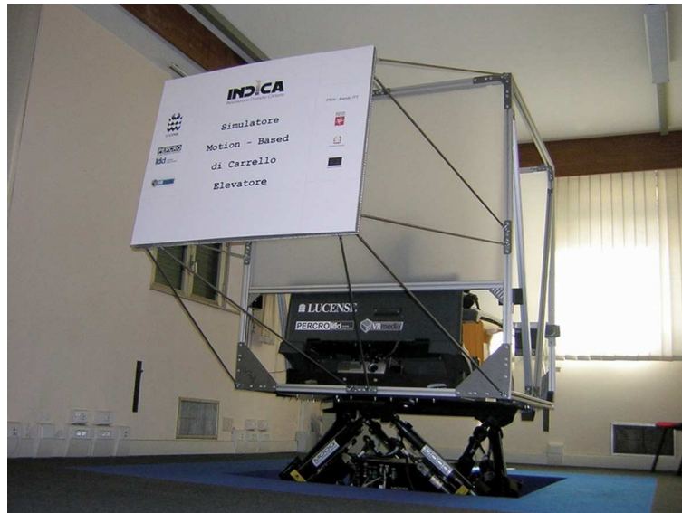
Figura 1.1: Il simulatore di carrello elevatore sviluppato nel progetto INDICA
