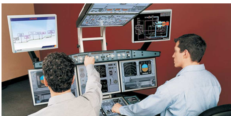
Figura 2.6: Mock-up del simulatore Simfinity realizzato dalla CAE. Questo mock-up riproduce il cockpit di un aereo grazie all'uso di 6/7 schermi touch screen
