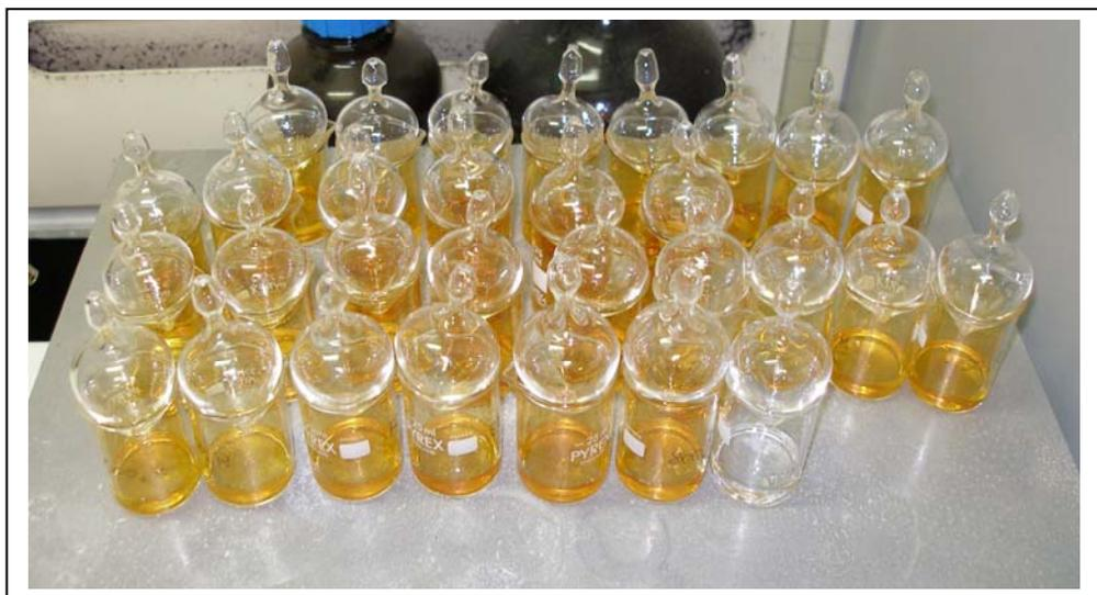
**Figura 2.16** *Batch* di campioni di piante in digestione in acido nitrico. Il bulbo in vetro a chiudere ciascun becker permette di far condensare in parte i vapori sprigionati durante la mineralizzazione su piastra riscaldante limitando le perdite di arsenico per volatilizzazione.
