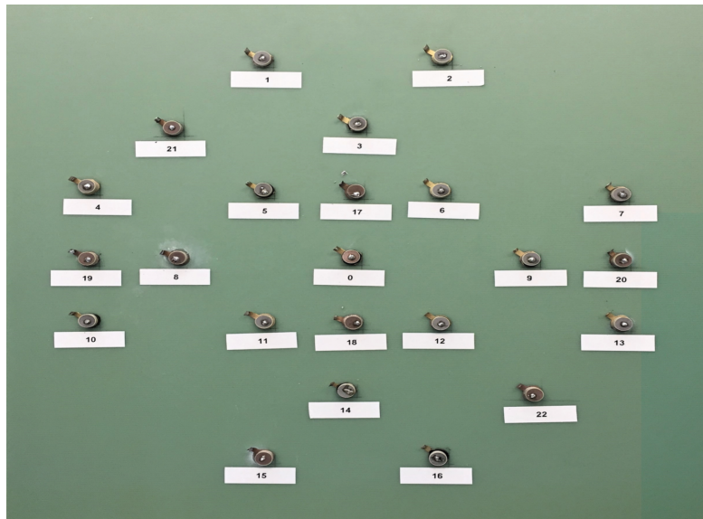
ABBILDUNG 4. Positionen auf der Strukturoberfläche für die Applizierung der Piezoelemente. Die Position 0 befindet sich in der Mitte der Platte. Abbildung entnommen aus Fu (2017).
