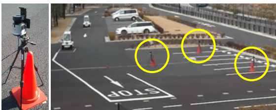
図2 地上設置したLiDAR
