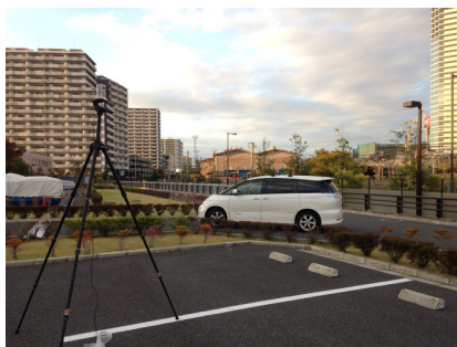
図12 LiDARによる車両認識・制御の様子
