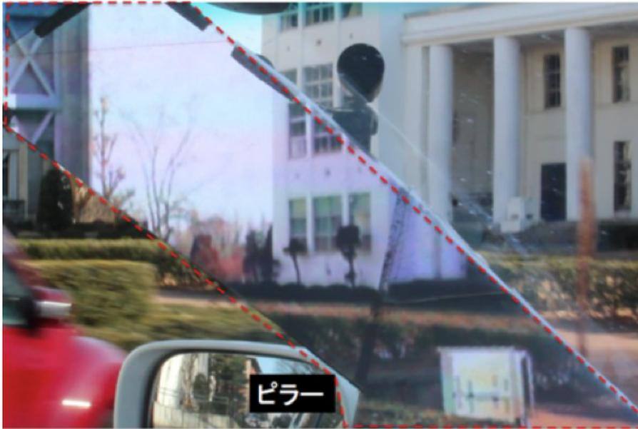
図 4.4: ピラー透明化の映像
