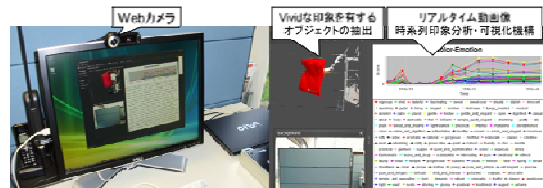
図2 Webカメラから取得されるリアルタイム動画像を対象とした色彩感性自動分析機構の実装
