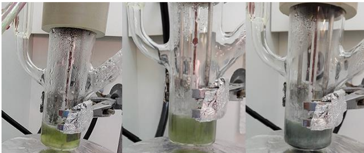
Fig. 11 – Ensaio 5: fotografias tiradas ao longo do ensaio; a da esquerda tirada após 13 minutos, a do centro tirada após 28 minutos e a da direita tirada após 3:50h de aquecimento.
