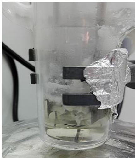
Fig. 18 – Ensaio 13: fotografia tirada após a adição da anilina (formação do composto intermediário).
