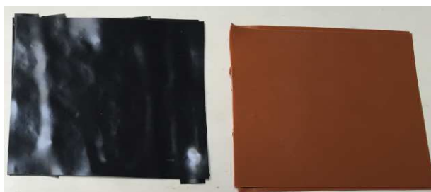
3. ábra: Szétválasztott gázálló és sima lágy PVC réteg
