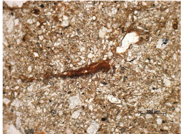
Abb. 5.1.46: Toneinspülung in der Hauptlage
