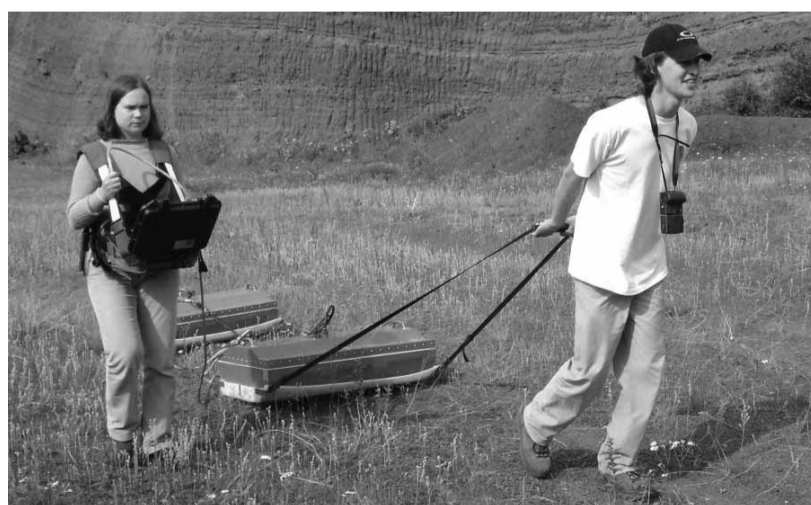
Untergrundwissen: Messungen mit dem Georadar machen Unterschiede in der Gesteinbeschaffenheit sichtbar. So lassen sich Ascheschüttungen unterscheiden, die im Hintergrund auch an der Steinbruchwand erkennbar sind. Georadar wird auch zum Orten archäologischer Strukturen eingesetzt – siehe oben
