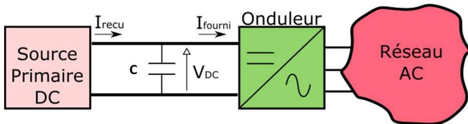
Figure 2 : Schéma simplifié d'une production se raccordant sur le réseau par un onduleur
