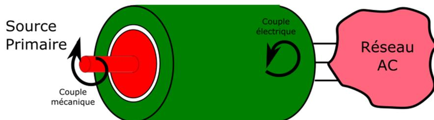
Figure 1 : Schéma simplifié d'une machine synchrone raccordée au réseau alternatif (AC).
