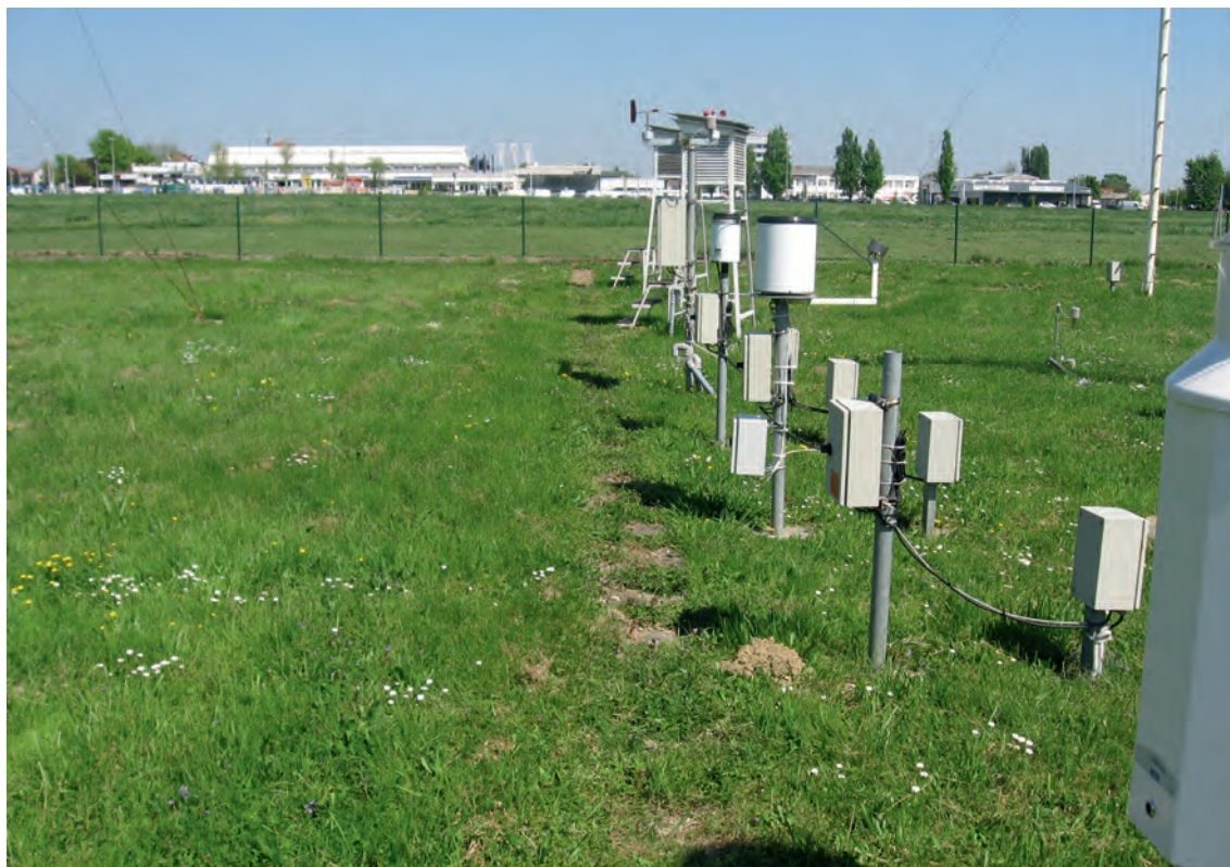
Slika 9. Postava automatskog mjernog sustava – tip F (Ispitni poligon na Meteorološkom opservatoriju Zagreb Maksimir).
