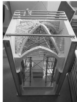
Abb. 13: Modellbau des Mittelschiff-Gewölbes des 2. Jochs von Osten (mehrere Abfolge-Fotos)
