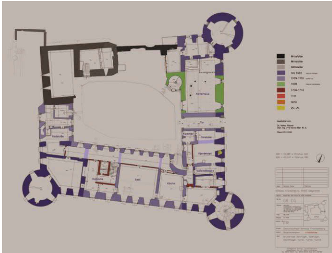
Farbabb. 9: Frankenberg, Grundriss EG mit Bauphasen und Raumnutzungen. Bernd Marr, Volker Rößner 2009 (Beitrag Breitling)
