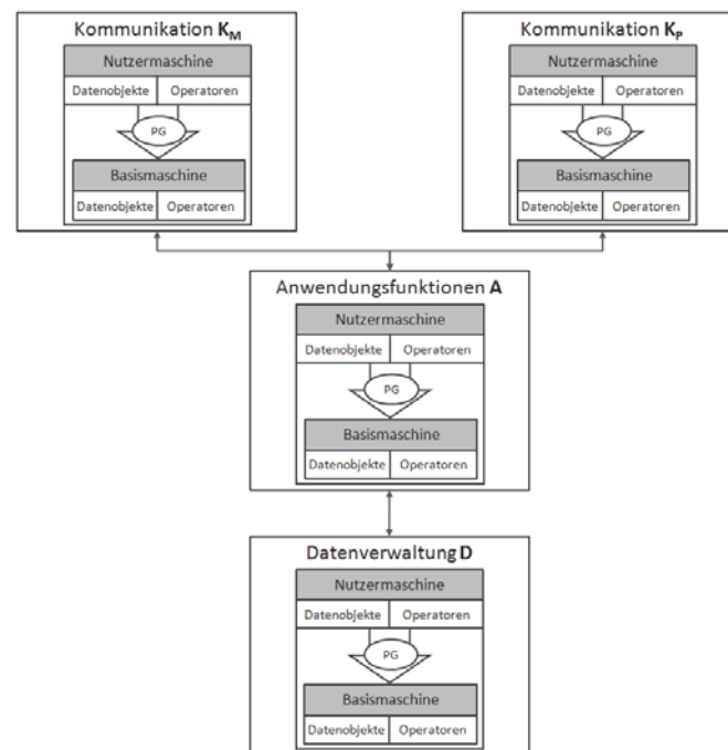
Abbildung 3.5: ADK-Strukturmodell eines Anwendungssystems (nach [FeSi06, 305])
