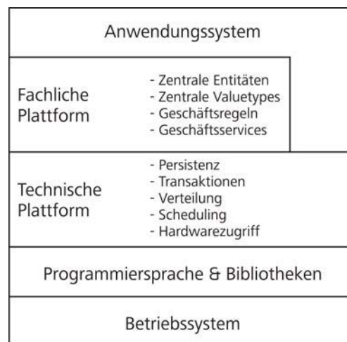
Abbildung 3.2: Schichten des Architektur-Referenzmodells [StVö05, 135]
