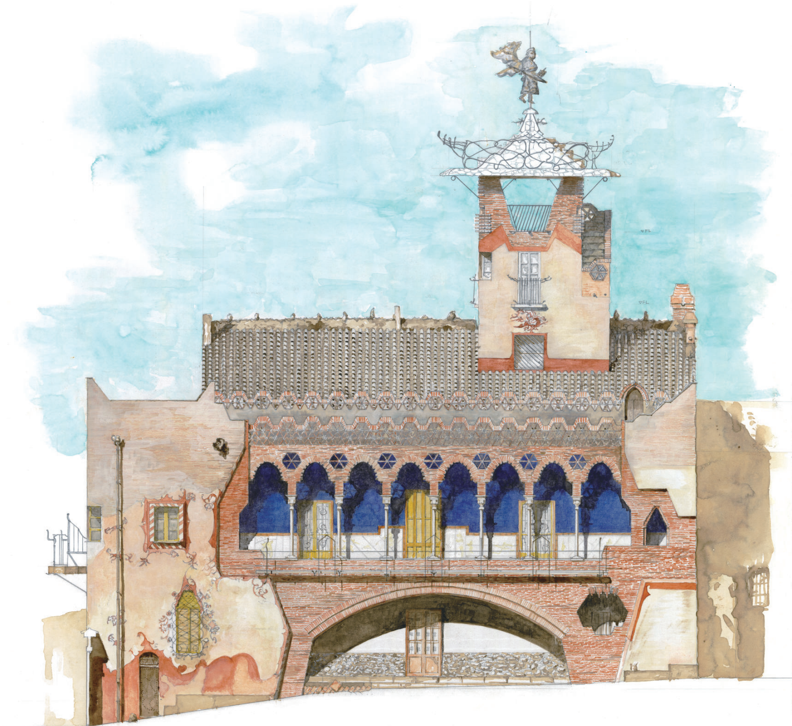
<カザ・プファルイ>南側（庭側）立面図 S:1/100 筆者らの実測による。水彩絵具による着彩
