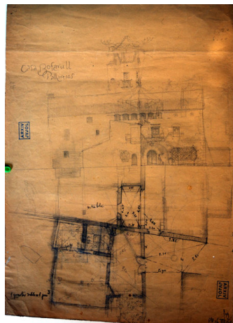
図 21) 改築案北側立面図および 1 階部分平面図 < 図面リスト 39 >
