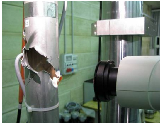
Figura 11: Fotografia di un albero danneggiato dopo l'impatto balistico.
