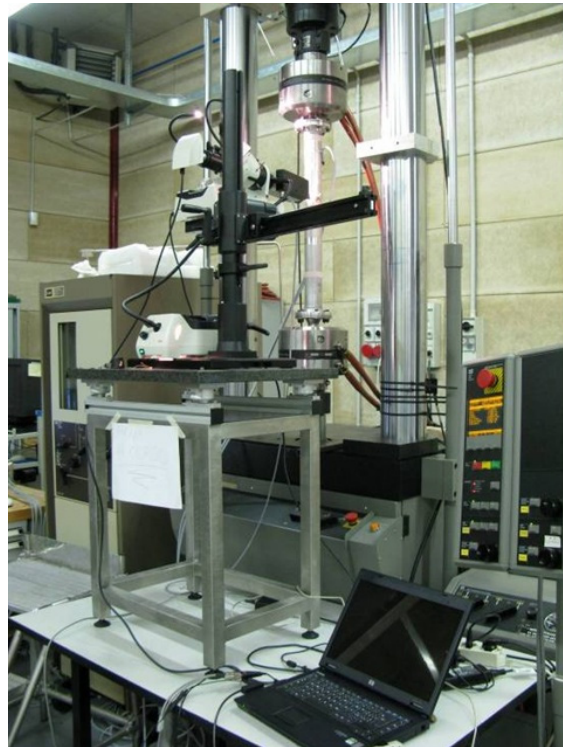
Figura 10: Strumentazione utilizzata per monitorare l'avanzamento delle cricche.
