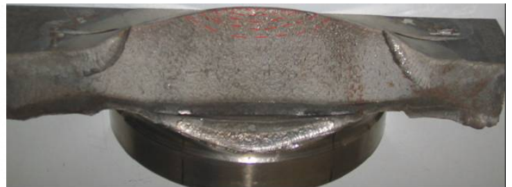
Figura 6. Superficie di frattura dell'albero a gomiti.
