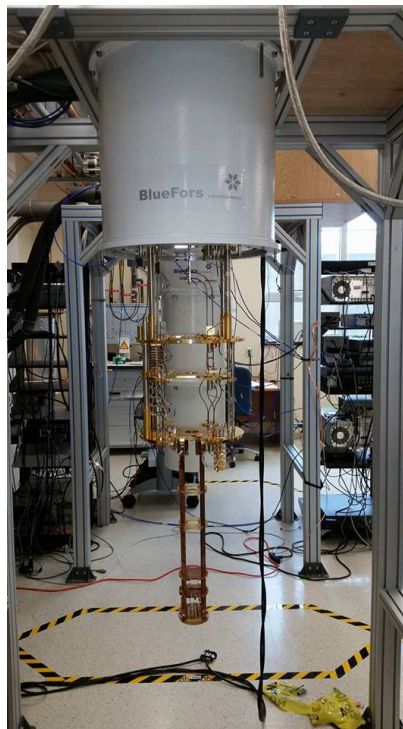
FIGURE 4.5 – Frigo à dilution ouvert. Nous pouvons y voir les différents plateaux donnant accès à divers températures.
