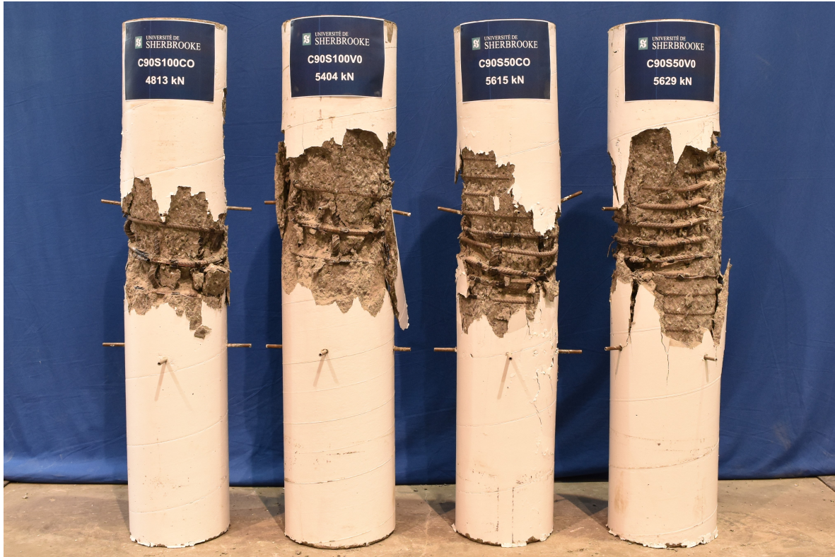
Figure 4.5 – Aspect des spécimens de la série 5 à la fin des essais
