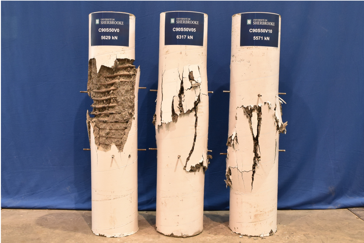
Figure 4.3 – Aspect des spécimens de la série 3 à la fin des essais
