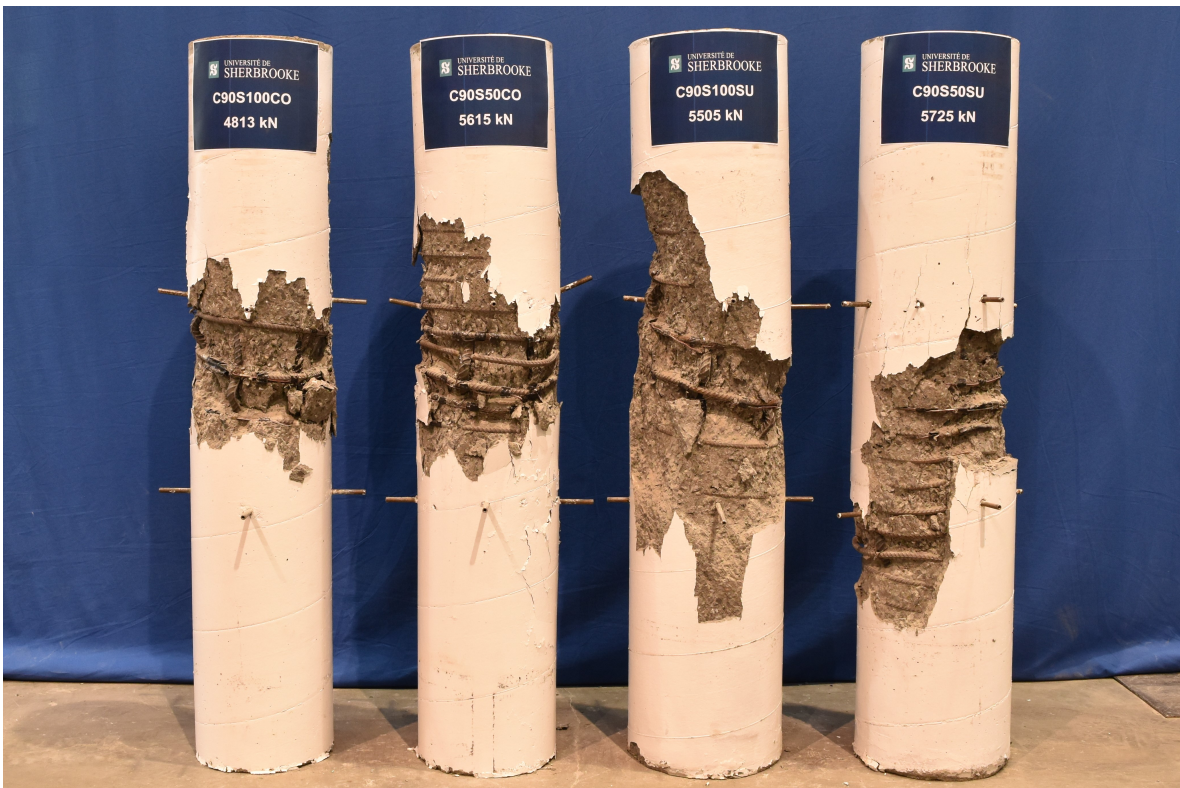
Figure 4.4 – Aspect des spécimens de la série 4 à la fin des essais
