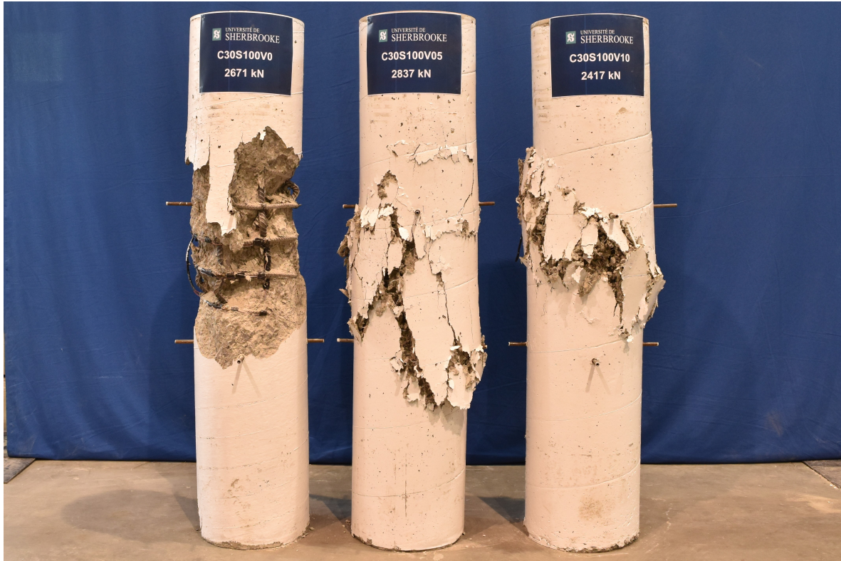
Figure 4.1 – Aspect des spécimens de la série 1 à la fin des essais
