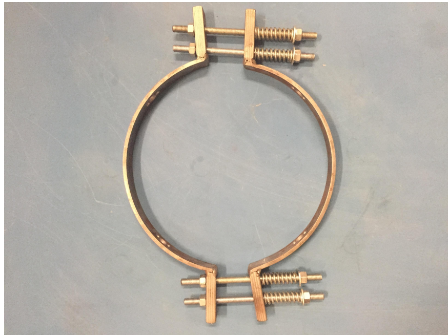
Figure 3.3 – Support métallique servant à retenir l'enrobage
