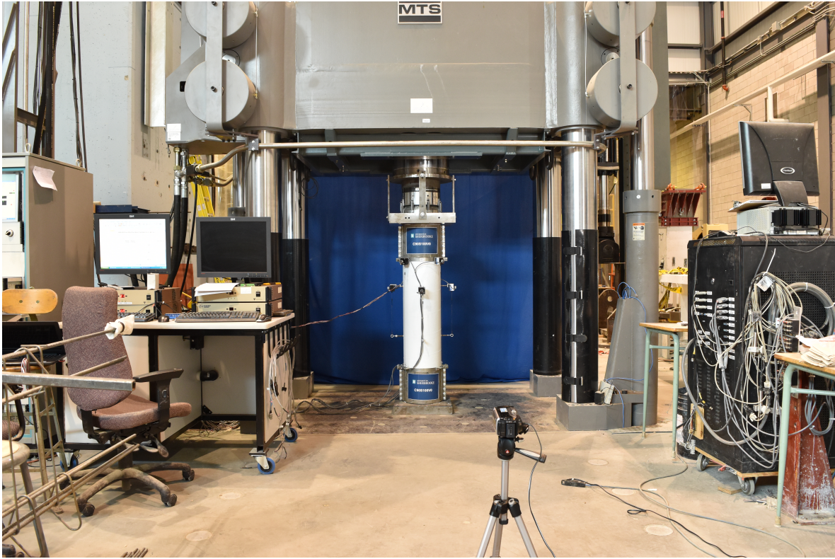
Figure 3.14 – Montage expérimental des essais sur les poteaux
