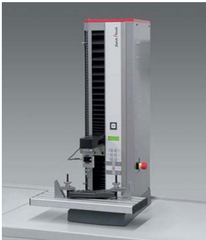
Gambar IV.1 Alat uji kekuatan mekanis: universal testing machine (Zwick 2.0,5)
