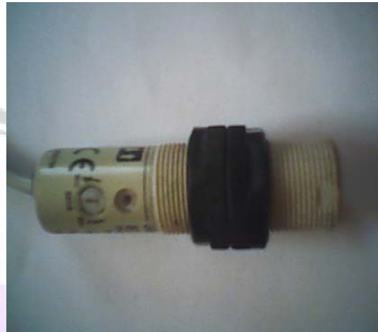
Gambar 3.6. Sensor Foto elektrik atau Optical Sensor
