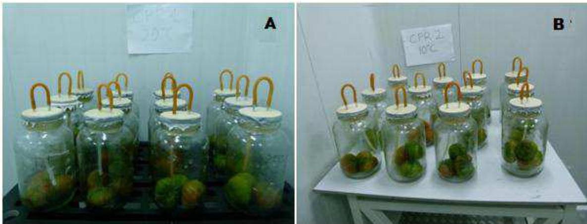
**Imagen 4.2.6.1.** Disposición de los recipientes y detalle de su sellado para la determinación de la tasa respiratoria y producción de etileno en sistema cerrado a las temperaturas de 20°C (A) y 10°C (B).
