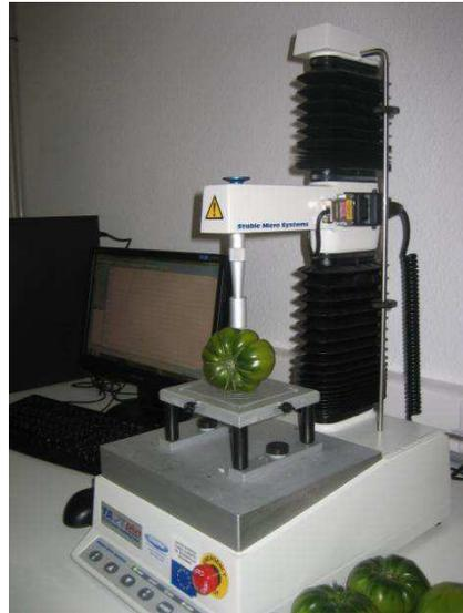
**Imagen 4.2.3.1.1.** Texturómetro empleado para la determinación de la firmeza en las muestras de tomate tipo Raf (cv. Delizia)
