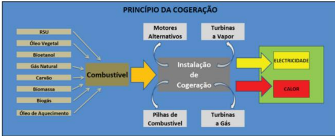
Figura 2.1 – Princípio de um sistema de Cogeração [12]
